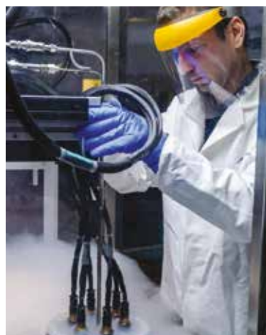
Tests de résistance à la pression pour les capteurs d'Ariane 5 (Le Haillan)
