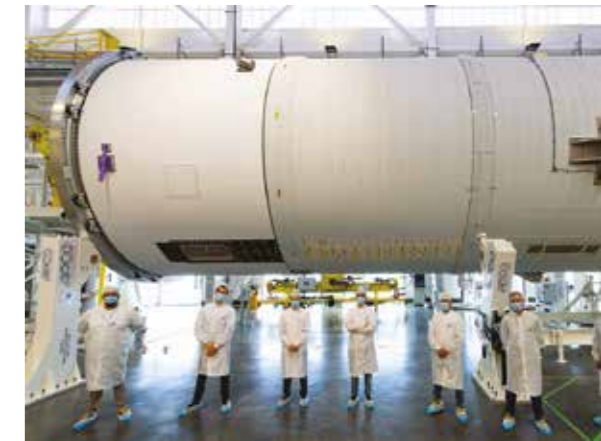
Réservoir d'oxygène liquide Ariane 6 pour essais combinés (Les Mureaux)
